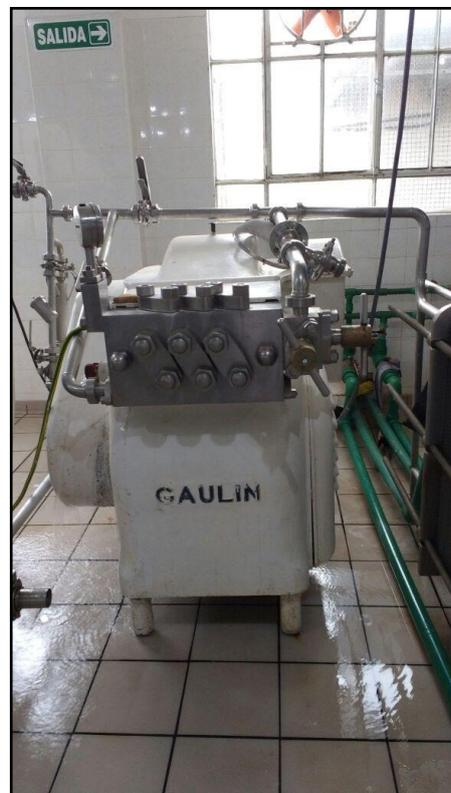
**Figura 15.** Homogeneizador empleado en la elaboración de crema helada, en cuyo piso se puede observar el incorrecto drenaje del agua de limpieza.
