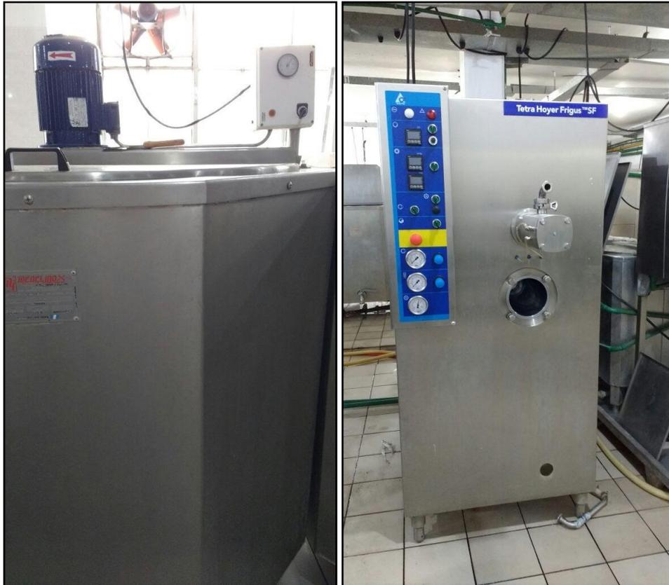
**Figura 18.** *Pasteurizador y madurador con control de temperatura.*
