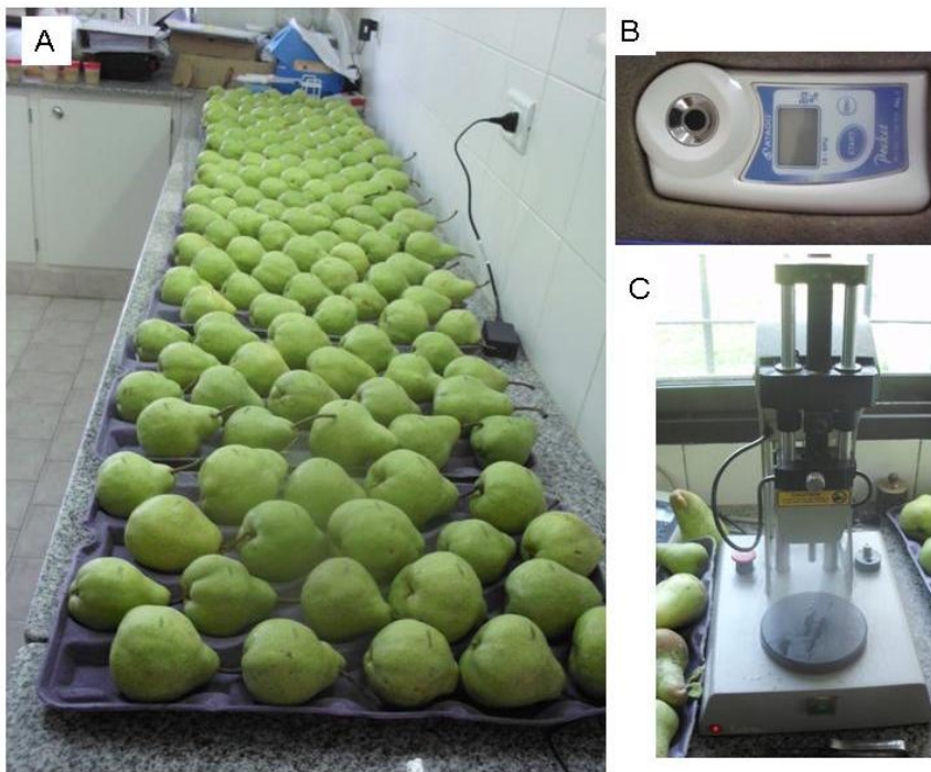
Figura 5: A. Bandejas de peras PackamsTriumph para realizar índices de madurez. B. Refractómetro autocompensado para la determinación de sólidos solubles. C: Presiómetro de laboratorio para determinación de firmeza.
