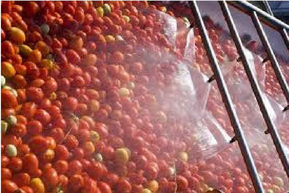
Figura 7. Lavado de tomates por aspersión.
