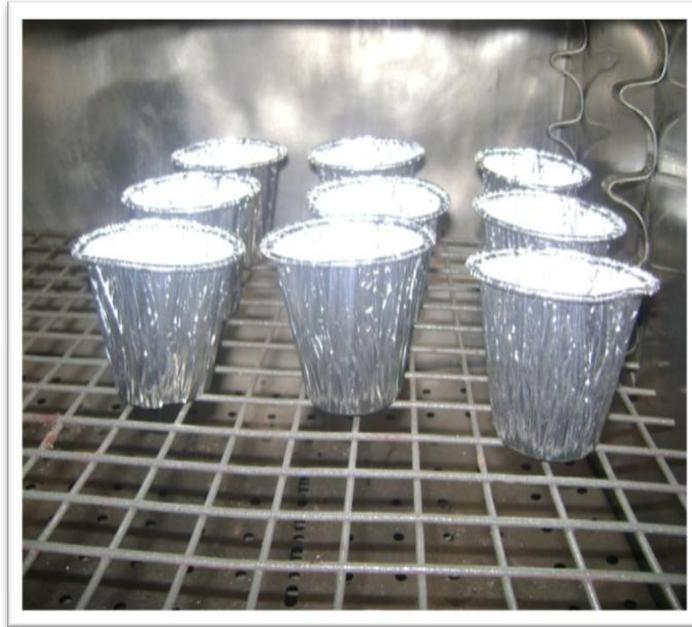
**Foto 16:** Muestras colocadas en estufa a temperatura de 105 ° C.
