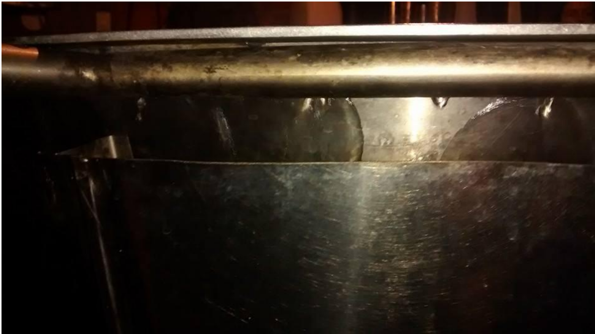
Fig.8- Sistema de enfriado de tina posterior a la pasteurización.
