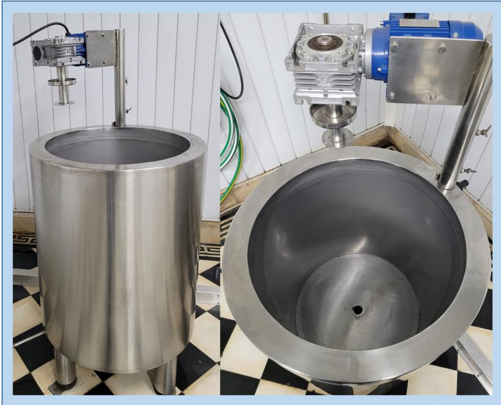
Figura 6: Tina de acero inoxidable con agitador automático de la planta piloto del curso de Agroindustrias.
